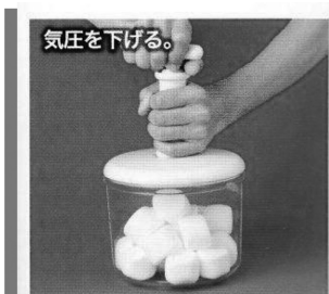
〔図3〕空気の圧力のはたらく向きを調べる実験 気圧を下げてふくらんだマシュマロは、気圧をもとにもどすと、同じ形のまま縮む。
