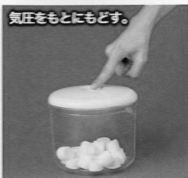
〔図3〕空気の圧力のはたらく向きを調べる実験 気圧を下げてふくらんだマシュマロは、気圧をもとにもどすと、同じ形のまま縮む。
